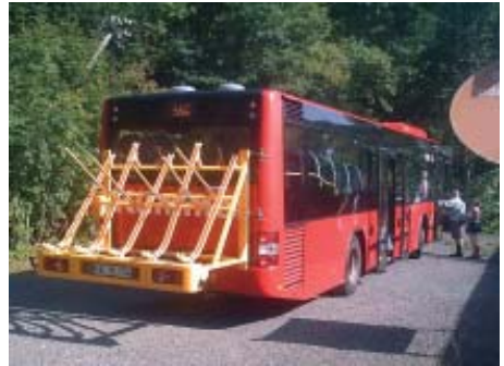
Bus mit Rucksack-Gestell zum Fahrradtransport der Ederseelinie des Anschlussverkehrs der Ederseebahn. Foto: Helfried Kohl
